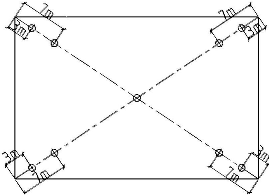
图 2.1 平房仓测气点平面位置图
